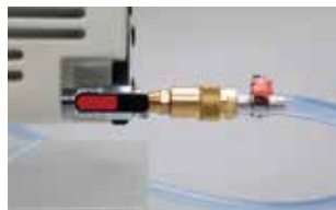
ポンプ接続部(カブラー接続)
